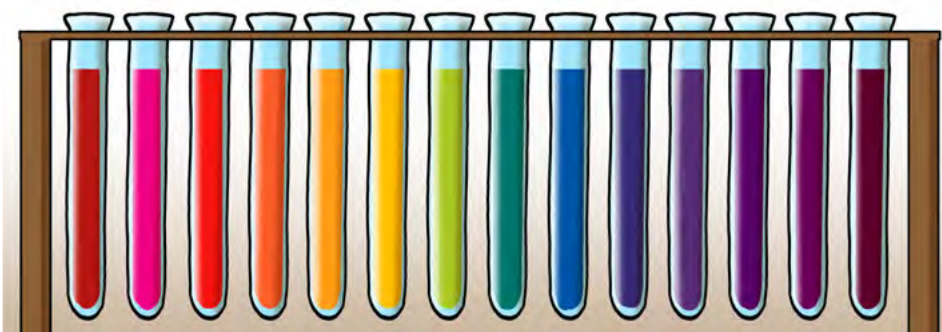
Universele indikatore kan baie verskillende kleure hê, van rooi vir sterk sure tot donkerpers vir sterk basiese. Die vloeistof in die middelste proefbuis is neutraal (pH=7) en dit word deur die groen kleur van die indikator aangedui.
