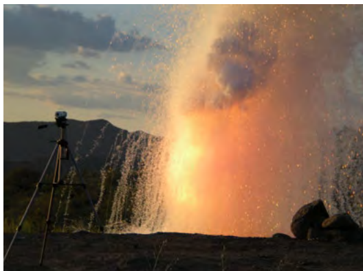
Wanneer groot hoeveelhede natrium met water in aanraking kom, is daar 'n ontploffing, soos in hierdie foto waar water op 1,5 kg natrium gegooi is.
