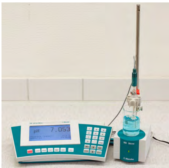
'n pH-meter meet die pH van 'n oplossing in 'n laboratorium.
